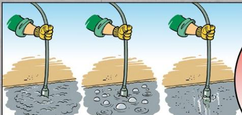
Nech beton úplně usadit. Vibrátor rychle ponoř.
