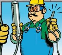
Použij ponorný vibrátor správného průměru a se správnou frekvencí.
