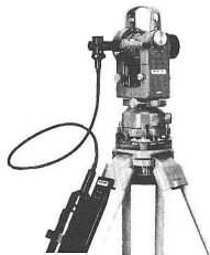
Obr. 135 • Teodolit Wild s nasazeným laserovým okulárem Wild GLO 2
